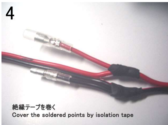
電源側をチューブカバー付きにする (ショート防止) Covered by tube to power supply
